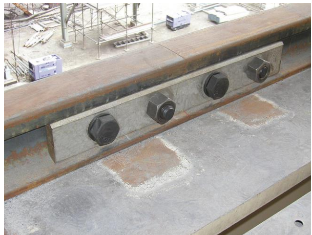
写真 2. クレーンレール用の SMA 製継目板
