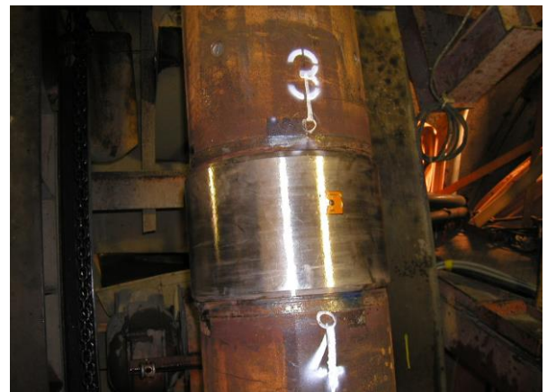
写真1. SMA継手による曲線鋼管の接続 7)
